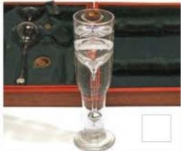
Rezipient zur Luftpumpe mit Vorrichtung zum Filtrieren von
